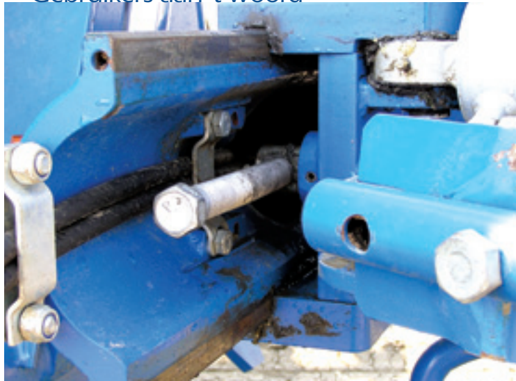
Het instellen van de werkbreedte gebeurt met een bout op de kop van de ploeg. Deze is goed te verstellen met behulp van een buissleutel.
