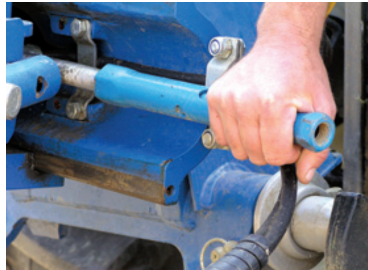
Het instellen van de werkbreedte gebeurt met een bout op de kop van de ploeg. Deze is goed te verstellen met behulp van een buissleutel.
