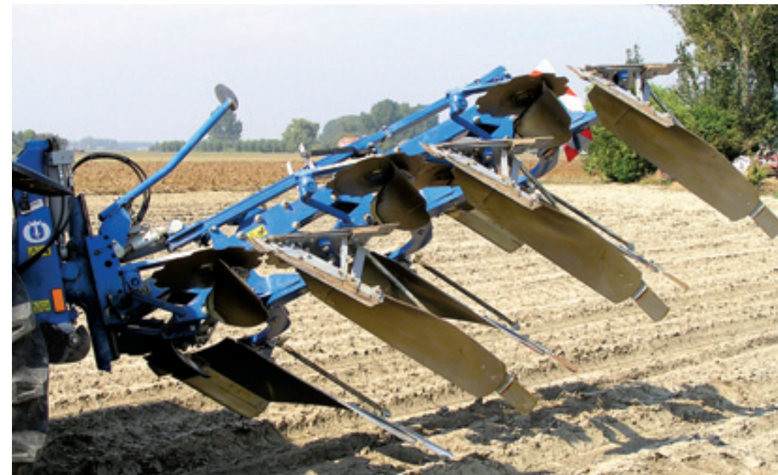
De ploeg wentelt overbuik. Op deze manier heb je een grote bodemvrijheid.
